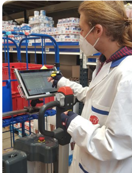
Der Kommissionierer ruft sich die Bestellungen auf dem Tablet auf (linkes Bild). Über einen Fingerscanner werden die Artikel identifiziert und automatisch dem aufgerufenen Beleg zugeordnet.
