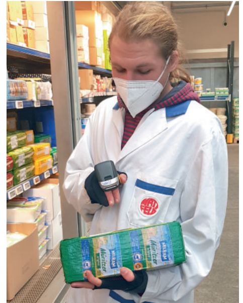
Der Kommissionierer ruft sich die Bestellungen auf dem Tablet auf (linkes Bild). Über einen Fingerscanner werden die Artikel identifiziert und automatisch dem aufgerufenen Beleg zugeordnet.
