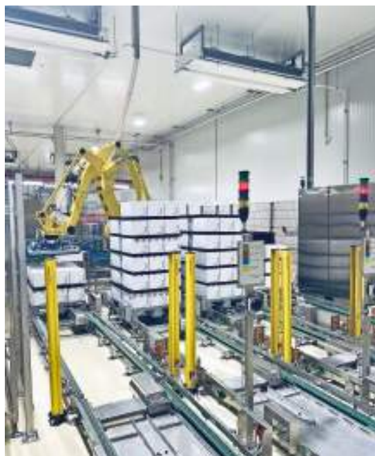
Daisy in Aktion: Der Palettierungs- roboter stapelt die fertigen Kartons auf Zielpaletten.
