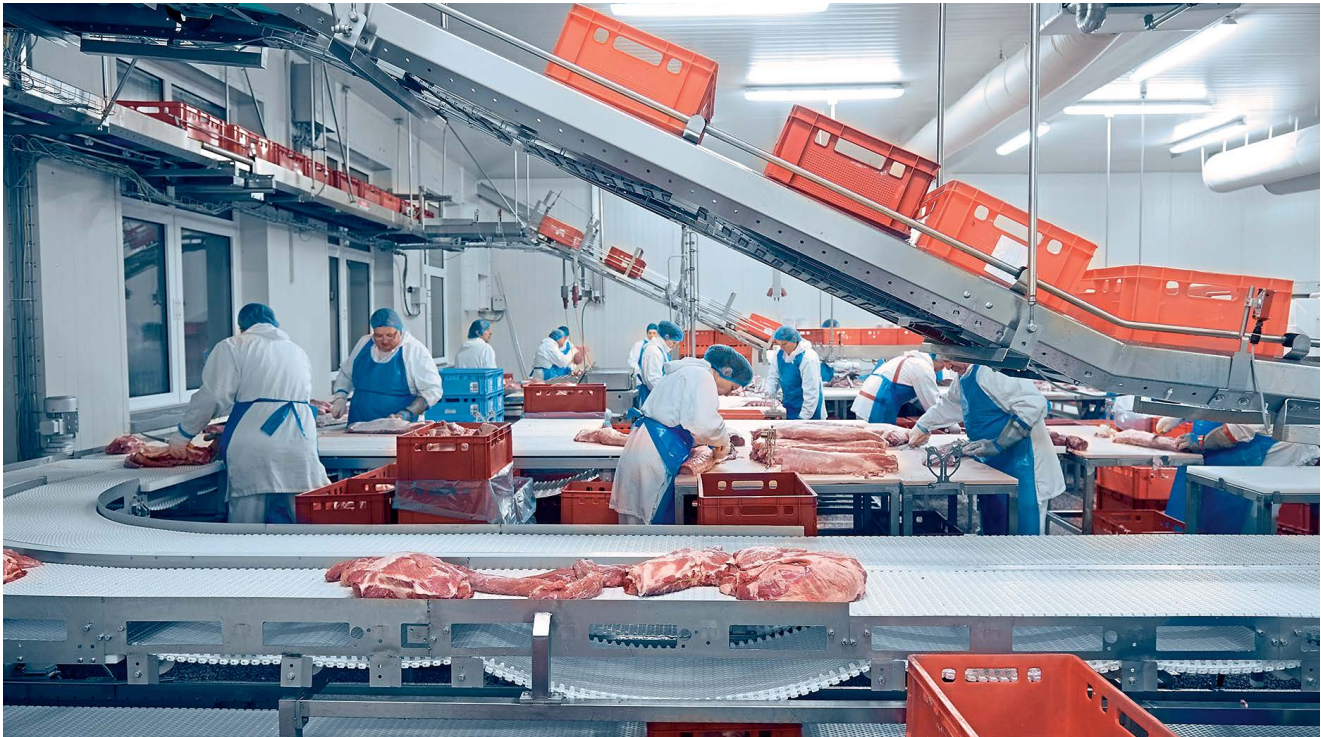
Mit winweb-food wird jede E2-Kiste automatisch identifiziert und je nach Artikel und Ziellager weiter transportiert.
