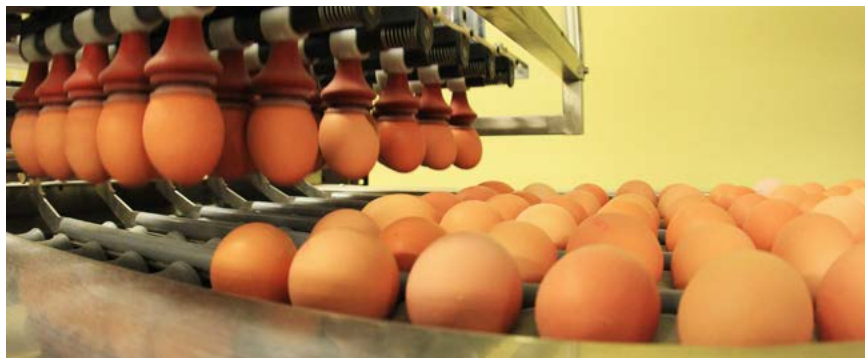
Die Eier werden in der Sortieranlage automatisch nach Größe und Qualität sortiert und in winweb-food gebucht.
